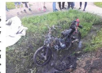
Причиной пожара послужило короткое замыкание электропроводки в двигателе.
