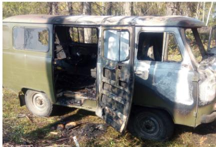
пожара явился аварийный режим работы электрооборудования автомобиля.
